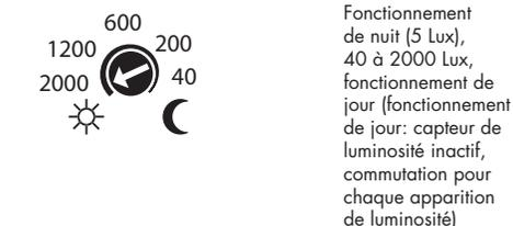
Fonctionnement de nuit (5 Lux), 40 à 2000 Lux, fonctionnement de jour: capteur de luminosité inactif, commutation pour chaque apparition de luminosité
